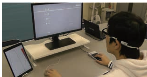
図2. 心的作業負荷を推定する生体計測実験
