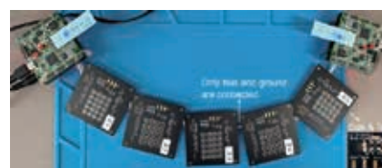
2.7mm□のMEMS-LSI集積化触覚センサを100個シリアルバス接続したシステム
