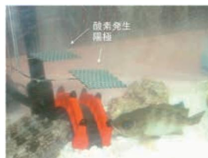
図3 海水魚飼育水槽中での酸素発生電極による電気分解
