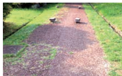
木質舗装実証試験(奈良県森林技術センター)
