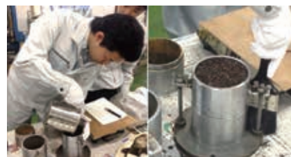
舗装材の性能試験用サンプル(マーシャル供試体)の作成
