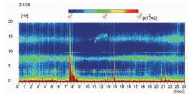
宮城県大崎市鳴子川渡でインダクション(誘導)磁力計によって観測された磁場変動のスペクトルの例。7Hz, 14Hzに帯状に見られるのは、雷による磁場擾乱が地球と電離層の間で共振して起こるシューマン共振である。
