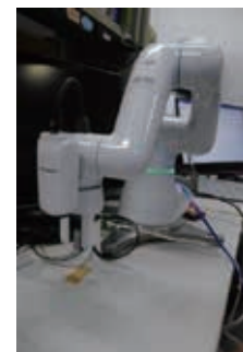
把持対象物の距離、接触状況および材料の種類を判別可能なセンサを搭載したロボットアーム
