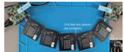
2.7mm□のMEMS-LSI集積化触覚センサを100個シリアルバス接続したシステム
