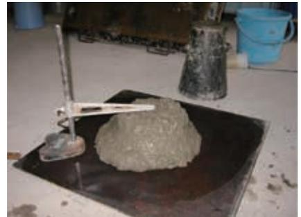
繊維補強材料のスラブ試験状況
