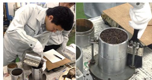
舗装材の性能試験用サンプル（マーシャル供試体）の作成
