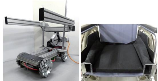
(a) 移乗ロボット (b) 専用吊具兼敷物
