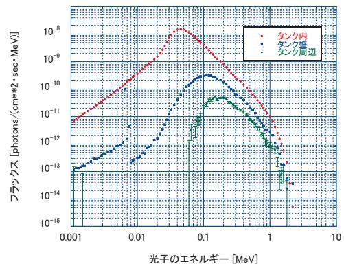
図2 RO濃縮水貯蔵タンクに含まれ<sup>90</sup>Yからの制動放射スペクトル
