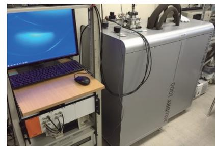
低温・強磁場環境でのデバイス評価装置
