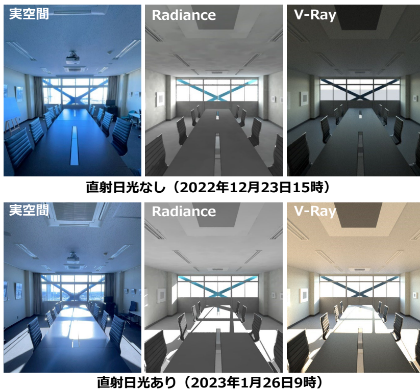
図4 作成したマンションモデルと光環境シミュレーションの出力例
