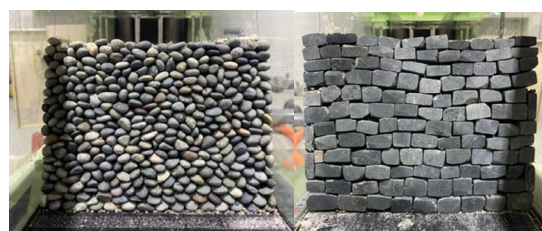
(a)野面積み (b)切り込み接ぎ 図6野面積みと切り込み接ぎ
