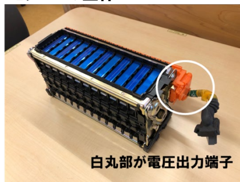
図1 廃蓄電池モジュール(HONDA: Fit)全体写真
