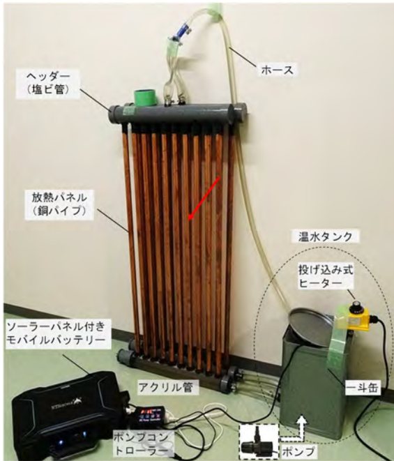
Fig.3 太陽熱を利用した移動式暖房パネルシステム(試作)
