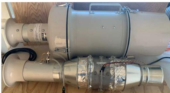
昨年度既に整流風洞（ベルマウス）の小型化を実現。左の写真は風洞を小型化した旧型。交流ファンを使用しているためファンの大きさが小型化への障害である。
