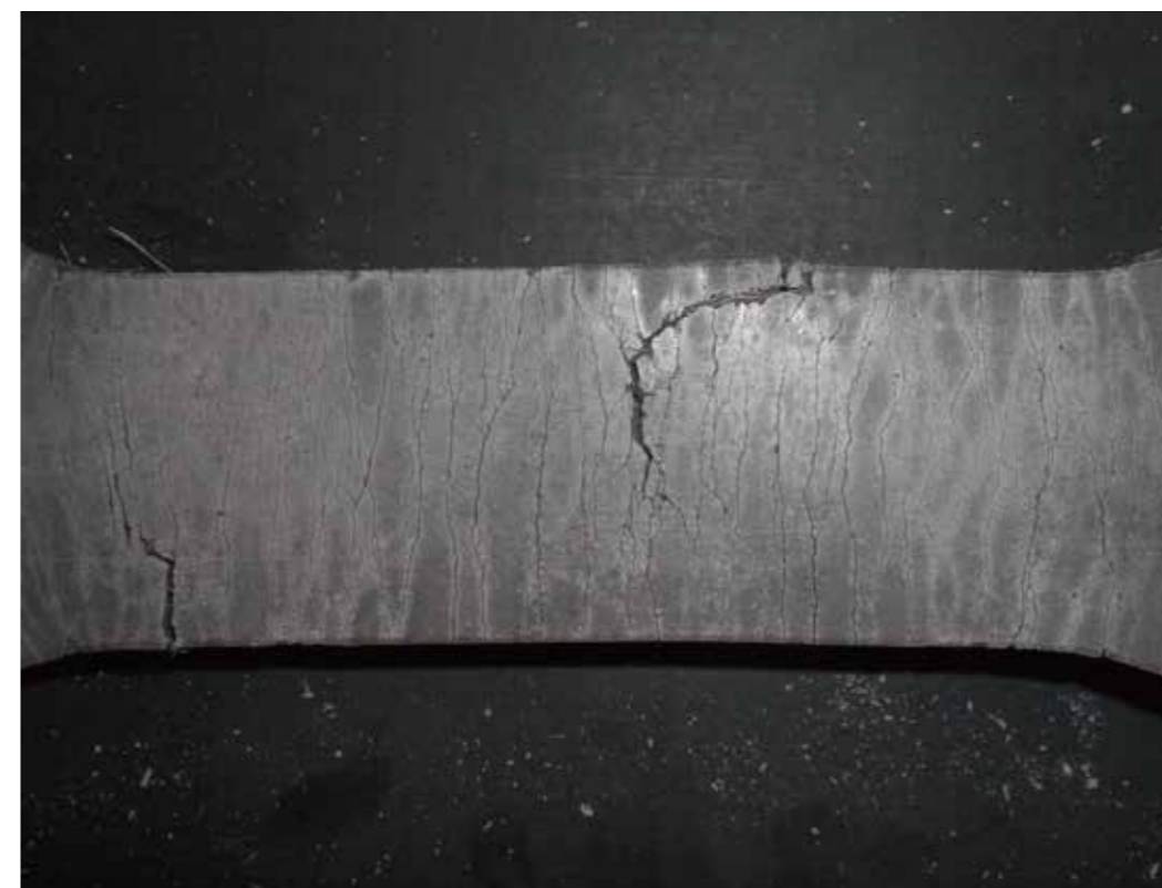
コンクリートに発生するひび割れ
