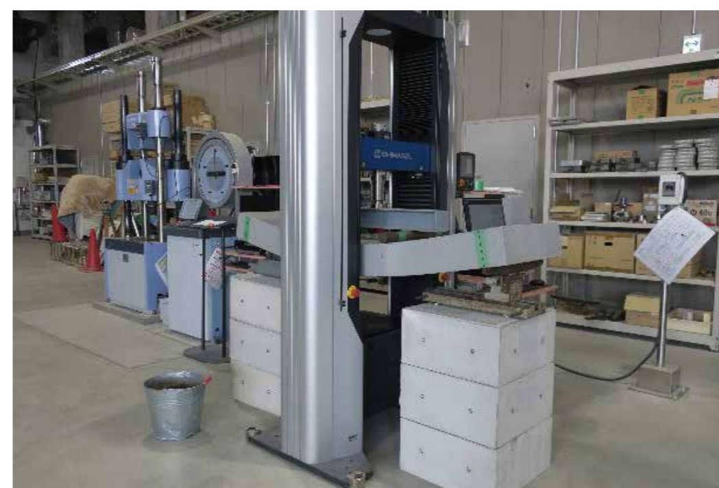
発泡スチロール板の曲げ試験
