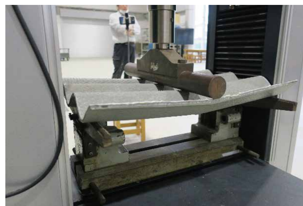
スレート板の曲げ試験(波型の板)
