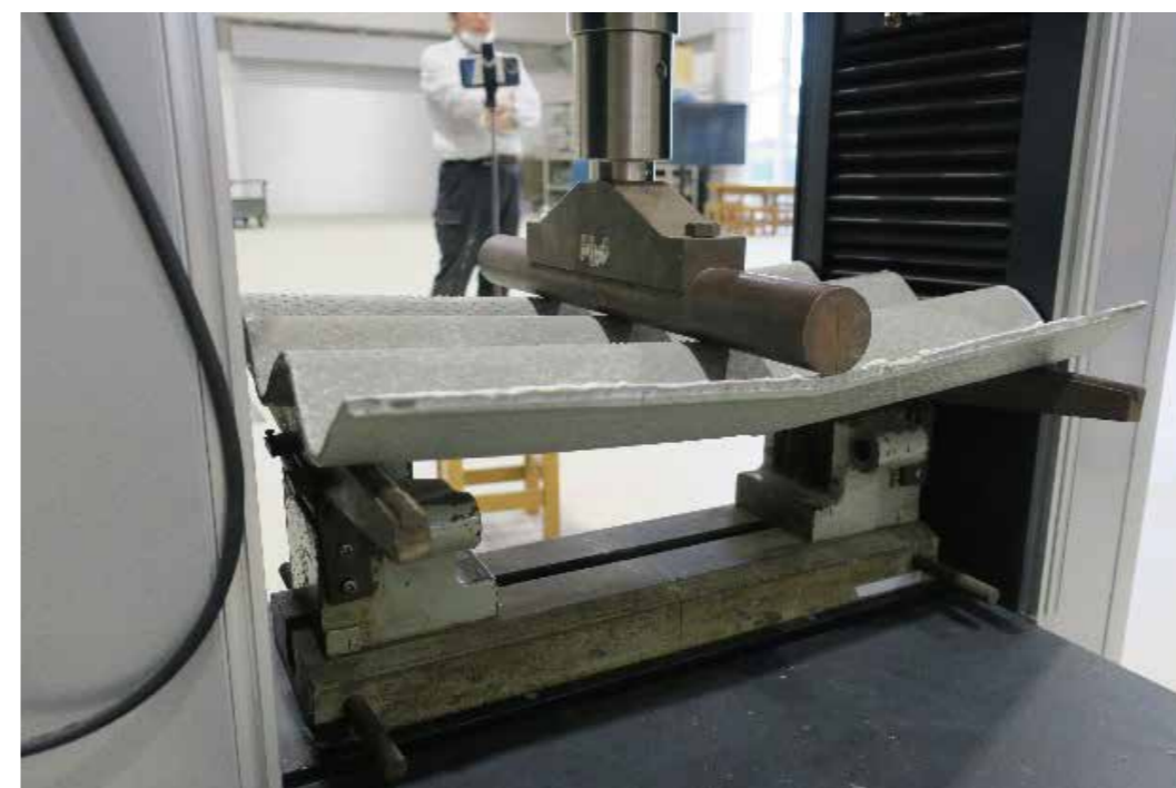
スレート板の曲げ試験(波型の板)
