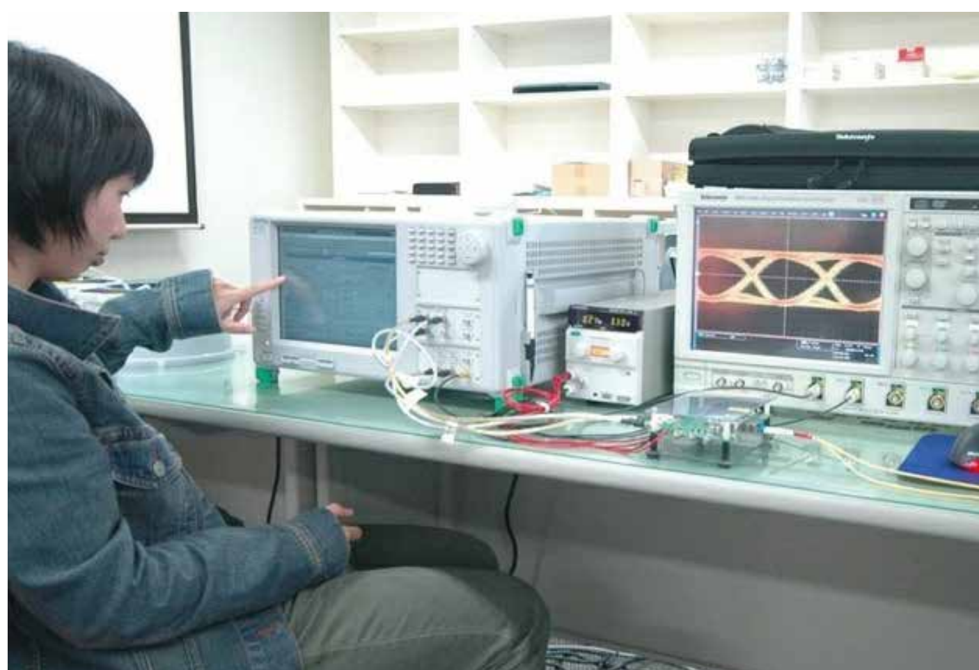
高速光通信対応BER(ビット誤り率)測定システム
