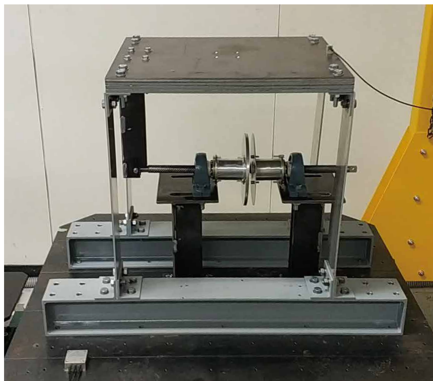
開発中の渦電流を使った制振装置の実験様子
