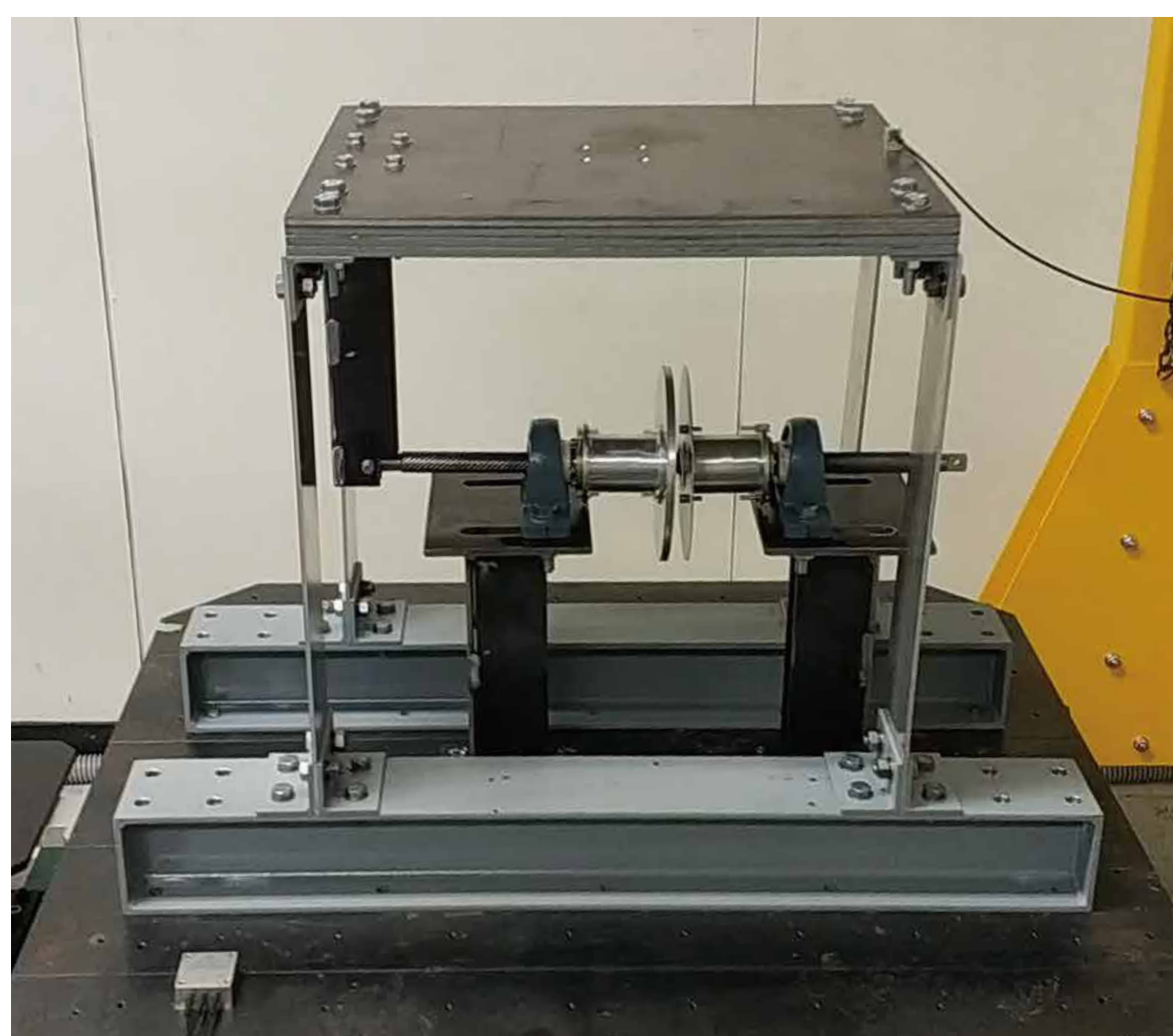
開発中の渦電流を使った制振装置の実験様子
