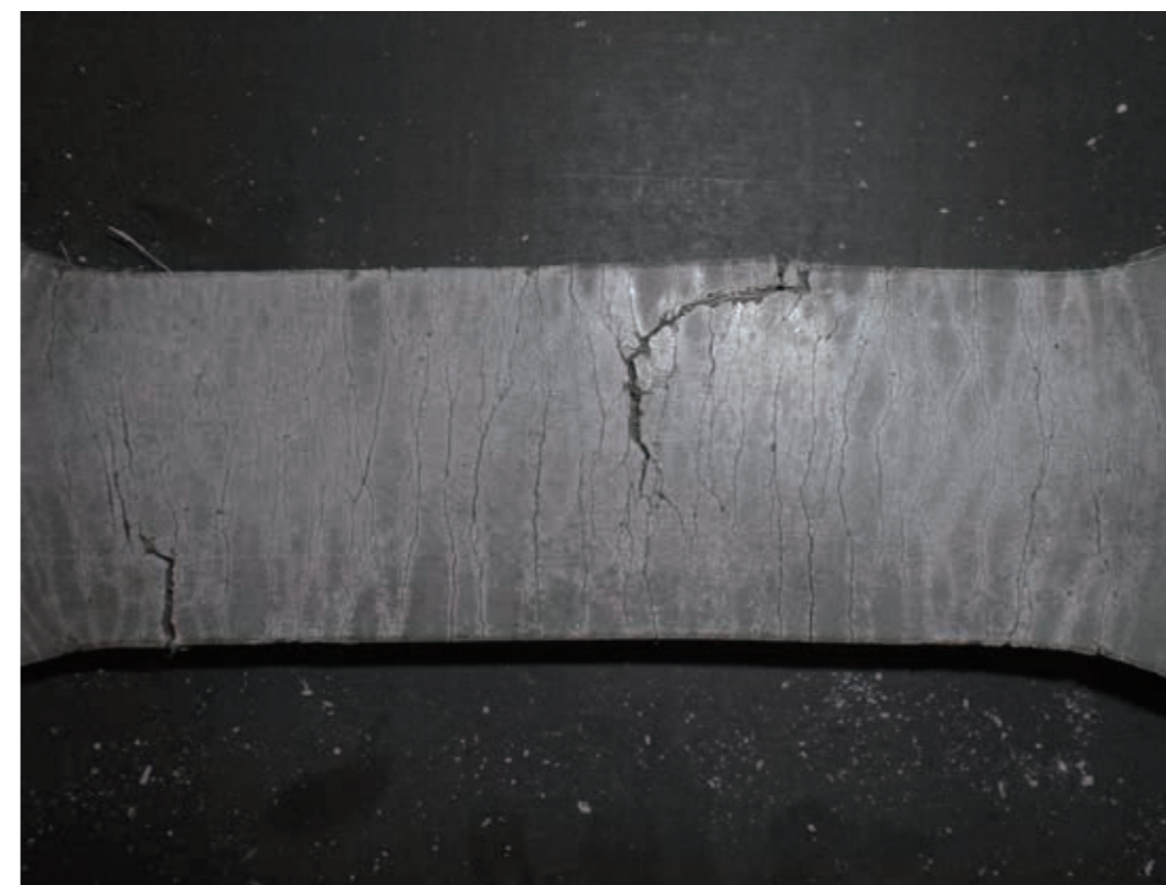
コンクリートに発生するひび割れ
