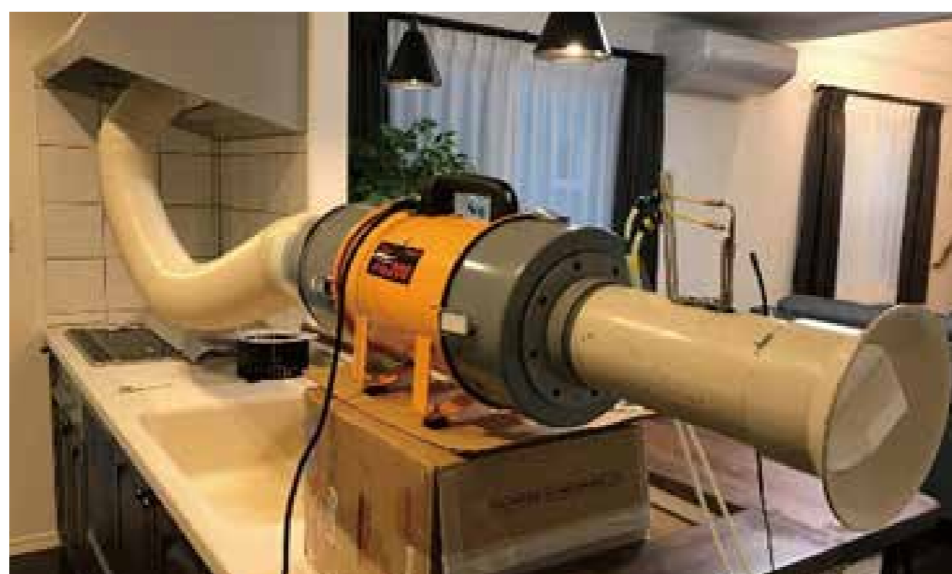
厨房換気扇法試験計測
