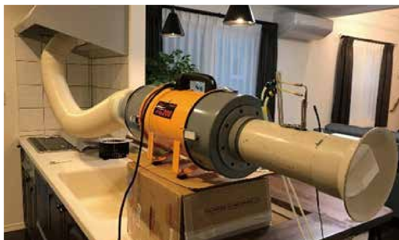
厨房換気扇法試験計測
