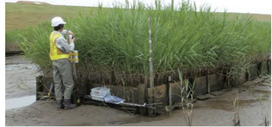
製鋼スラグをかさ上げ材に活用した被災ヨシ原湿地再生の実証試験
